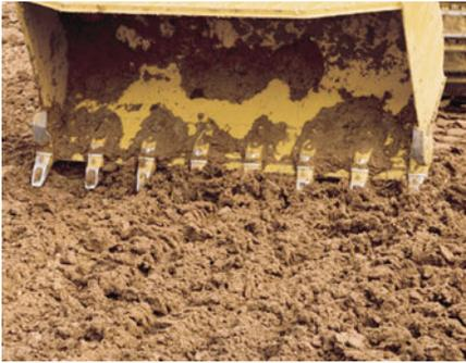
**Ковш общего назначения.** Ковши общего назначения (GP) обеспечивают исключительную грузоподъемность и длительный срок службы в таких областях, как извлечение грунта из твердых отвалов, удаление верхнего слоя и загрузка отвалов. Высокопрочная низколегированная сталь, из которой изготавливаются ковши, снижает риск появления выбоин и потертостей.
