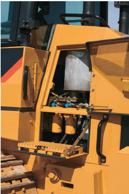
**Отсеки с левой стороны.** Левый моторный отсек имеет два навинчиваемых фильтра гидравлического масла, обеспечивающих очистку масла гидростатической системы.
