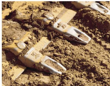
**Система зубьев серии K™.** Система зубьев серии K позволяет продлить срок службы наконечников и переходников, сократить продолжительность цикла, увеличив вместимость ковша, и снизить нагрузки, действующие на машину, что, в конечном итоге, способствует сокращению эксплуатационных затрат.
