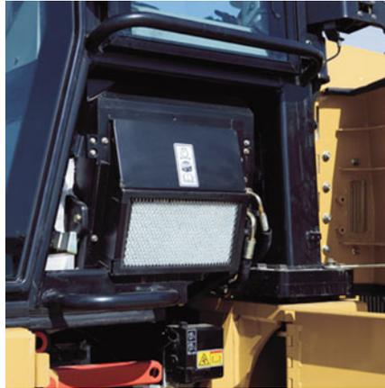
**Воздушный фильтр кабины.** Воздушный фильтр кабины, сгруппированные штуцеры для измерения давления, запорный брус блокировки наклона кабины, гидроцилиндр наклона (по заказу) и ящик для инструмента для удобства доступа располагаются под левым окном кабины.
