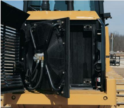
**Система охлаждения.** Вентилятор и решетка откидываются, обеспечивая хороший доступ при необходимости очистки и технического обслуживания машины. Решетка с фиксатором, предназначенная для тяжелых условий работ, сводит к минимуму скопление грязи.
