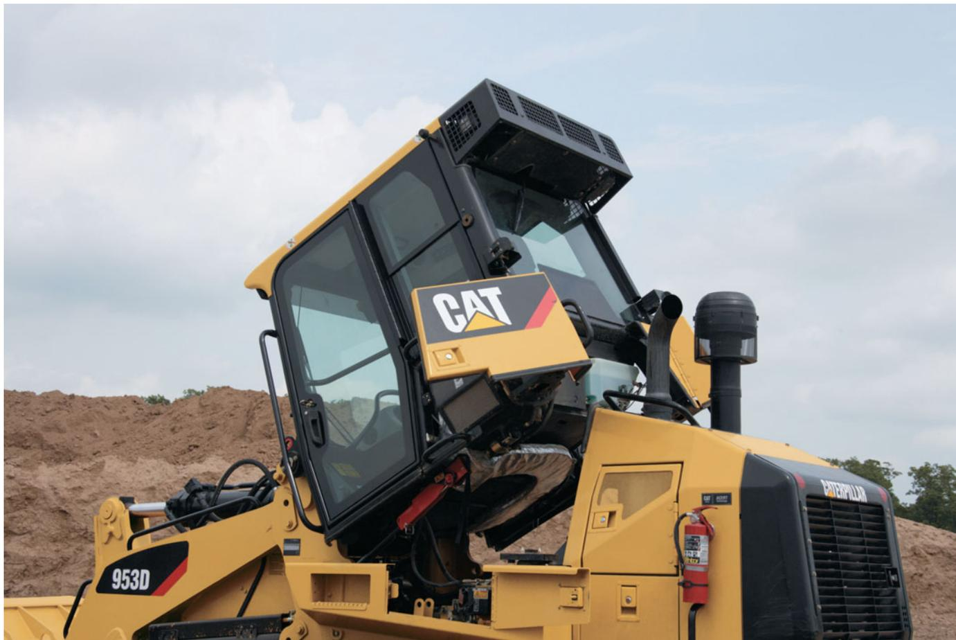
**Откидная кабина.** Погрузчик 953D оснащается откидной кабиной, что позволяет упростить процесс технического обслуживания и ремонта. Наклонив кабину, вы получите доступ к силовой передаче и возможность выполнить полное обслуживание гидросистемы.
