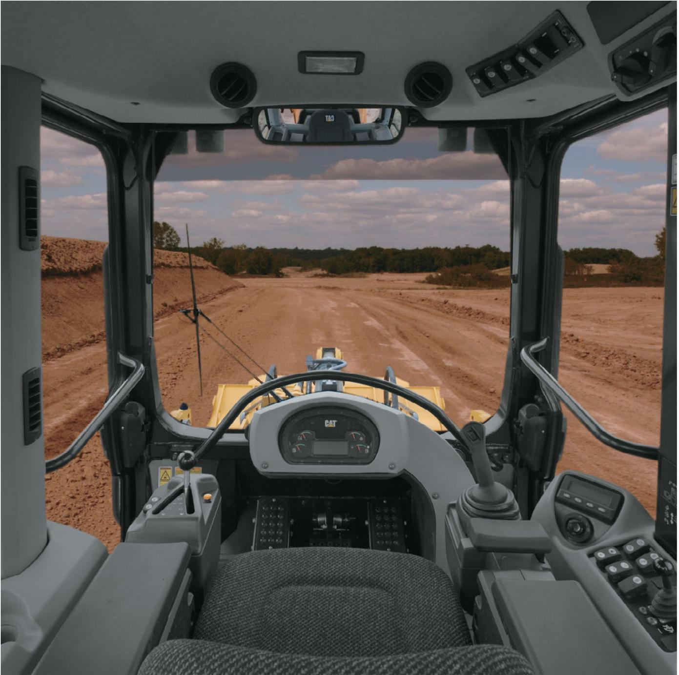
**Система отопления и кондиционирования воздуха.** В стандартной комплектации моделей 953D предусмотрено наличие системы кондиционирования воздуха. Система отопления и система кондиционирования воздуха обеспечивают подачу очищенного воздуха под давлением и определенной температуры к оператору и на стекла через 10 вентиляционных отверстий.
