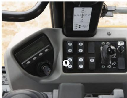
**Система пуска.** Электронный кулисный переключатель выбора скорости хода (А) располагается на правой панели управления и используется для регулирования частоты вращения коленчатого вала двигателя. Блок управления двигателем ADEM A4 всегда выполняет запуск двигателя на низких оборотах холостого хода. Частота вращения коленчатого вала двигателя отображается на цифровом дисплее панели приборов в зоне расположения указателей или в меню эксплуатационных характеристик системы Messenger.
