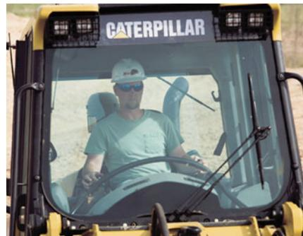
**Обзор.** Большие окна выполнены из затемненного стекла, уменьшающего блики, и обеспечивают прекрасный обзор ковша, гусениц и корпуса двигателя в задней части машины. Боковые окна опускаются вниз, позволяя оператору обеспечить приток свежего воздуха в кабину и разговаривать с находящимися снаружи людьми.
