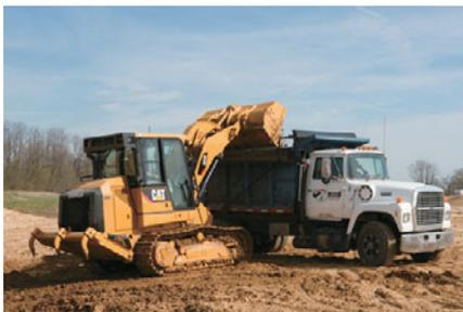
**Автоматические ограничители.** Включенные в стандартную комплектацию программируемые автоматические ограничители отличаются гибкостью работы и высокой производительностью, что позволяет обеспечить точную установку ковша по высоте при погрузке и разгрузке. Чтобы запрограммировать ограничители наклона и подъема, необходимо перевести ковш или навесное оборудование в требуемое положение и нажать на кулисный переключатель в кабине.
