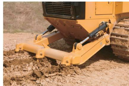
**Рыхлитель-корчеватель.** Радиальный рыхлитель-корчеватель можно установить на 953D в качестве дополнительного оборудования. Он крепится при помощи двух пальцев, которые вставляются с каждой стороны основной рамы. Два цилиндра обеспечивают подъем и опускание рыхлителя. Балка рыхлителя имеет три гнезда для крепления зубьев рыхлителя. Шесть пальцев рычажного механизма не требуют смазки.
