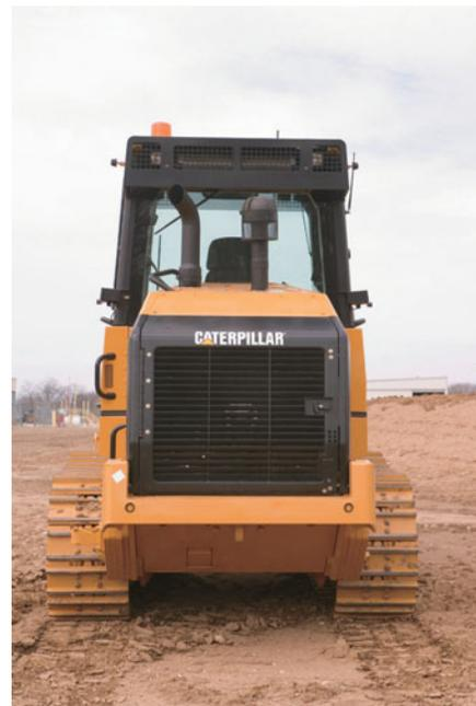
**Заднее расположение двигателя.** При расположении двигателя в задней части машины обеспечивается прекрасный передний обзор, а сам двигатель используется в качестве “работающего” противовеса. Кроме того, такое расположение двигателя предотвращает засорение радиатора и обеспечивает удобный доступ к двигателю и другим основным компонентам машины при необходимости их обслуживания.
