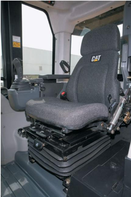
**Сиденье Caterpillar с пневмоподвеской.** Сиденье Caterpillar с пневмоподвеской и амортизатором поперечных колебаний имеет эргономичный дизайн и может легко регулироваться для обеспечения максимального комфорта оператора. Ремень безопасности с инерционной катушкой имеет ширину 75 мм и обеспечивает надежную и комфортабельную защиту.
