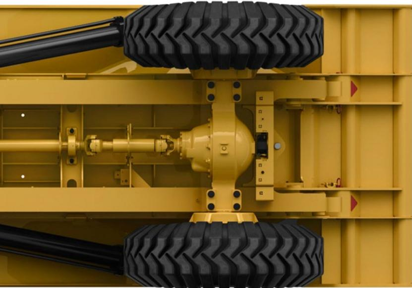
Конструкция рамы AD22 состоит из секций коробчатого сечения и имеет защиту днища двигателя и коробки передач. Наша конструкция коробчатого сечения, используемая во всех самосвалах Cat, позволяет раме справляться со скручивающимися нагрузками и ударными напряжениями.
