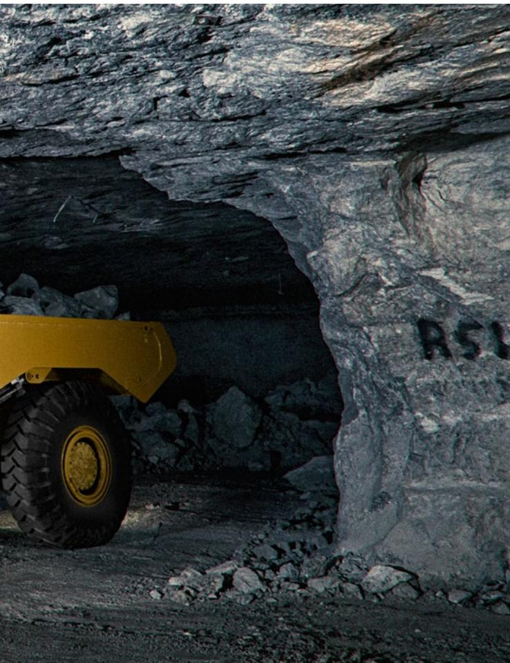
Еще одним фактором безопасности является превосходный обзор рабочей зоны с рабочего места. Зона перед самосвалом отлично просматривается, а зеркала и камера заднего вида позволяют оператору видеть происходящее по бокам и сзади рабочего пространства.
