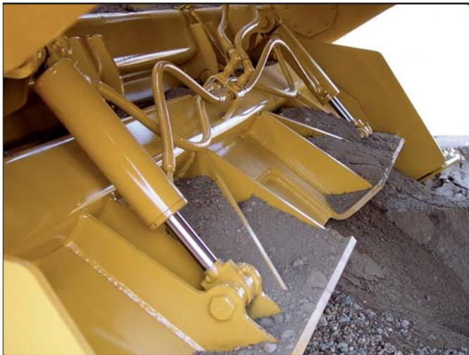
**Передний люк с гидроприводом.** Позволяет оператору открывать передний люк из кабины оператора.
