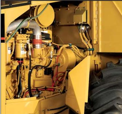
Места ежедневного технического обслуживания легко доступны с уровня земли и сосредоточены по одну сторону от двигателя. Боковые панели, установленные на петлях, широко открываются с уровня земли, обеспечивая общий доступ в отделение двигателя. Для более свободного доступа могут быть сняты нижние панели.
