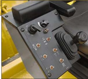
На боковом пульте управления расположены: мягкий подлокотник, выключатель четырех режимов управления поворотами, выключатель управления скоростью, рычаг управления передвижением, выключатель подъема ротора, выключатель управления крышкой переднего и заднего люка на колпаке ротора, выключатель управления поворотами задних колес и выключатель управления подвижной кабиной оператора.
