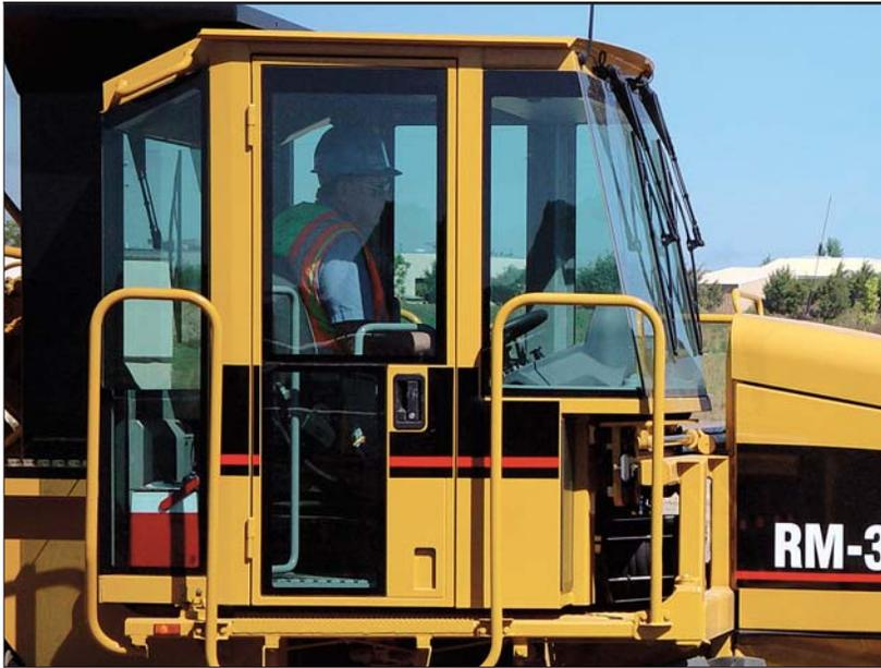
**Полное оборудование кабины.** Оборудование кабины включает: поворотное сиденье с тканевой обивкой, левую и правую боковые запираемые двери, тонированные стекла, кондиционер, обогреватель/антиобледенитель, сдвоенные передний и задний стеклоочистители/стеклоомыватели и звукопоглощающее напольное покрытие.
