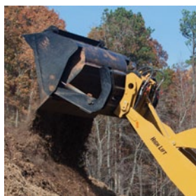
Рычажный механизм высокого подъема (930K и 938K)
