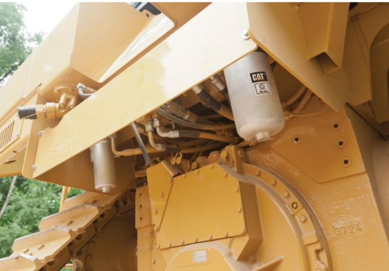
Централизованные точки технического обслуживания и упрощенные операции обслуживания обеспечивают увеличение полезного времени работы машины для повышения производительности и сокращения затрат.
